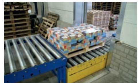
Een lift brengt de pallets op de juiste hoogte, waarna ze hun weg over de verpakingsstraat vervolgen
