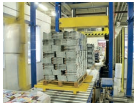
Voor een goede wikkeling wordt elke pallet opgetild
