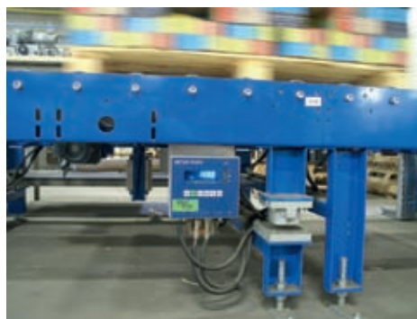
Elke pallet wordt gewogen. Als de gewogen waarde niet overeenkomt met het theoretische gewicht, wordt de pallet niet verpakt
