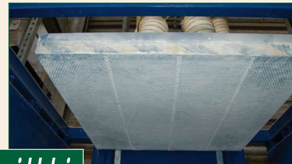
Detailopname van de stofafzuiging bovenin de bigbags-pers.
