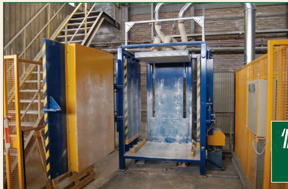
De bigbag-pers, met links de draaideur. Aan de bovenzijde is de stofafzuiging te zien
