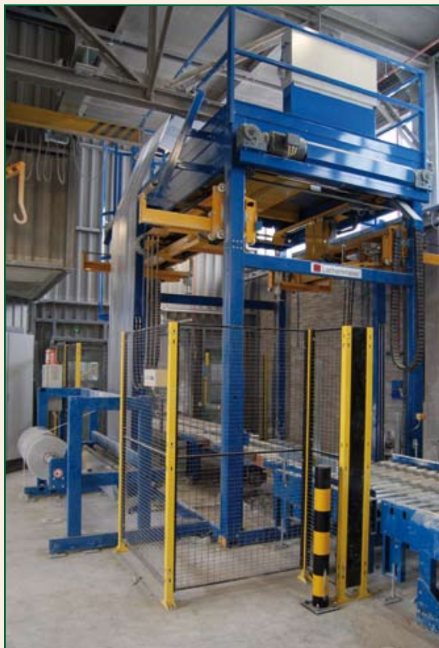
Pallet met zakgoed op rollenbaan naar de stretchhood-machine.
