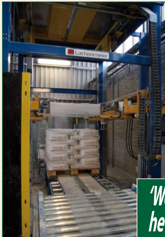
De hoed wordt van boven over de pallet getrokken.
