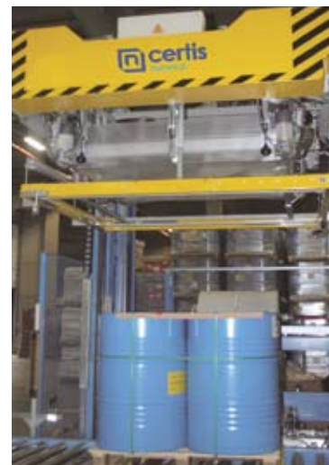
De Sirio ringwikkelaar van Certis werkt standaard met 240% voorrek. Met het gepatenteerde voorreksysteem is ook 300% mogelijk
