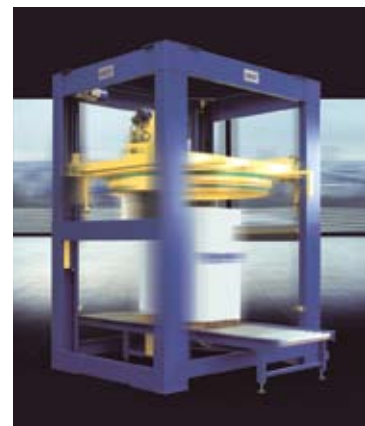
De Sirio ringwikkelaar van Certis werkt standaard met 240% voorrek. Met het gepatenteerde voorreksysteem is ook 300% mogelijk
